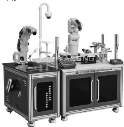
图1 亚龙 YL-17 型工业机器人装调与应用实训考核装置示意图
